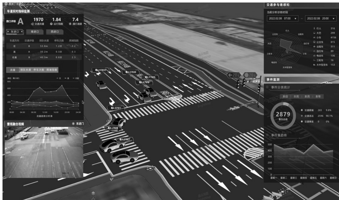
图2 基于数字孪生的网联虚拟仿真测试平台
